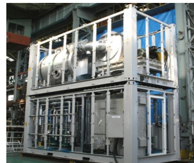
廃液の減溶化、有価物回収、蒸留水再利用 蒸発濃縮装置 Evaporating concentrator
